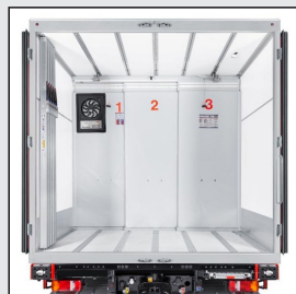
Cool Slide® als Kälterückhaltesystem oder Trennwand
