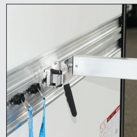
Ladungssicherung: JF-Schiene auf Wunsch vollversenkt für Zurrgurte, Sperrstange und JF-Hebel
