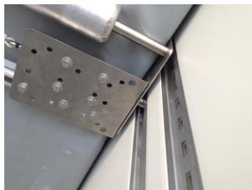
Zum Fixieren der Trennwand Entriegelungsschnur lösen und darauf achten, dass Bolzen seitlich in der Ladebalkenschiene einrastet.
