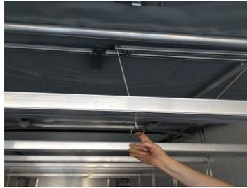
Arretierungsbolzen durch Ziehen der Schnur entriegeln
