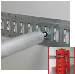
Ladungssicherung: Ankerschiene mit Absperstange oder Zurrgurt
