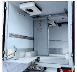
Eco Speeder als Mehrkammerfahrzeug mit zwei Verdampfern.
