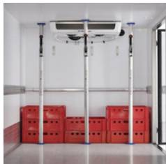
Ladungssicherung: Klemmbalken zwischen Boden und Decke gespannt
