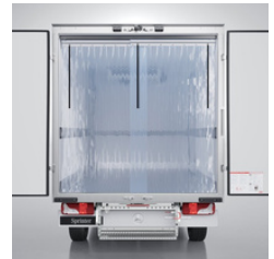
PVC-Kältevorhang, zweigeteilt, verschiebbar
