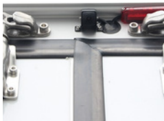
Rückfahrkamera: Sicherheit beim Rangieren
