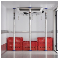
Ladungssicherung: Klemmbalken zwischen Boden und Decke gespannt
