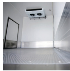
flüssigkeitsdichte Bodenwanne aus Aluminium-Gerstenkorn
