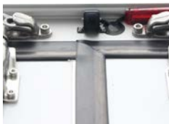
Rückfahrkamera: Sicherheit beim Rangieren
