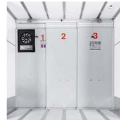
Cool Slide® Trennwand für Transporte in mehreren Temperaturbereichen
