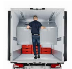
Cool Flap® leichte Trennwand, wird bei Nichtgebrauch zur Decke hochgeklappt
