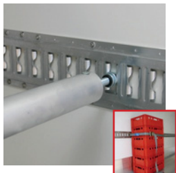
Ladungssicherung: Ankerschiene mit Abspernstange oder Zurrgurt
