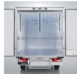
PVC-Kältevorhang, zweigeteilt, verschiebbar
