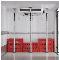
Ladungssicherung: Klemmbalken zwischen Boden und Decke gespannt
