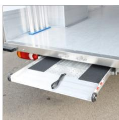
Die Rampe wird zwischen dem Rahmen eingeschoben und bei Bedarf ausgezogen.
