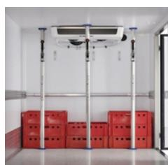
Ladungssicherung: Klemmbalken zwischen Boden und Decke gespannt
