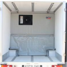
Cool Flap® - Trennwand wird zusammengeklappt an der Decke fixiert und einfach bewegt
