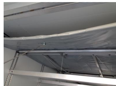
Trennwand mit der Stange nach hinten heraus ziehen, bis die TW mit der Hand greifbar ist.
