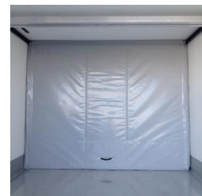
Trennwand in senkrechte Position bringen
