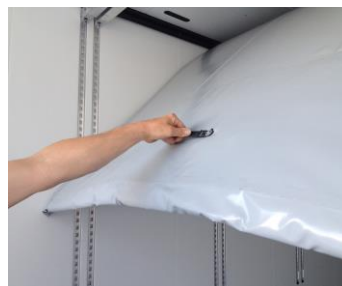
Trennwand von Hand bis zum Anschlag herausziehen, bis Trennwand selbstständig herunterklappt.
