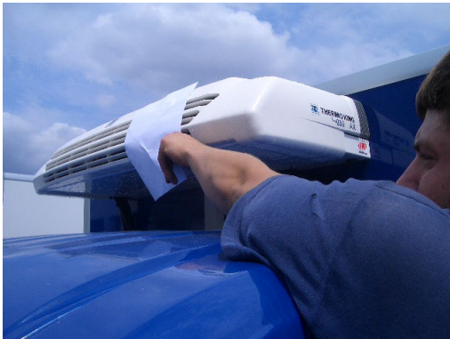
Blatt an Kondensatoreinheit legen
