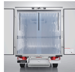
PVC-Kältevorhang, zweigeteilt, verschiebbar
