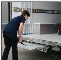
Über die Rampe lassen sich Rollcontainer oder Eurokisten auf Rollwagen einladen und ausladen. Die Rampe wird zwischen dem Rahmen eingeschoben und bei Bedarf einfach ausgezogen.
