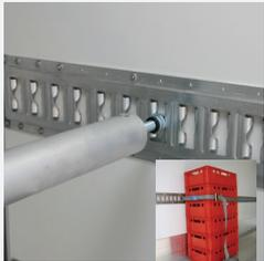
Ladungssicherung: Ankerschiene mit Absperrstange oder Zurrurgurt
