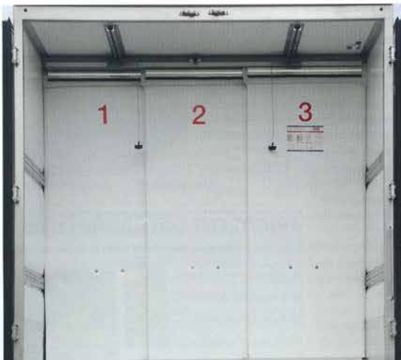
Damit die Transporttemperatur auch während Türöffnungen sichergestellt ist, bietet Kiesling zum Beispiel sein Cool Slide System an.
