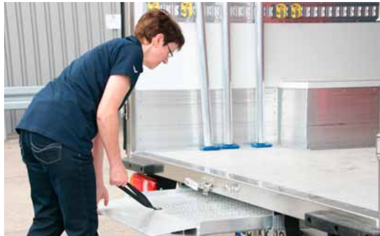
Während der Fahrt wird die Rampe in den Fahrzeugrahmen eingeschoben.
