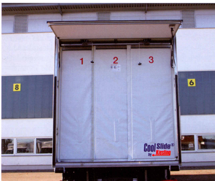
Cool Slide kann auch bei Ein-Temperatur-Fahrten als Kälterückhaltesystem eingesetzt werden.
