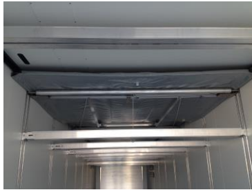
Grundstellung der Trennwand
