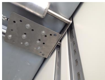
Zum Fixieren der Trennwand Entriegelungsschnur lösen und darauf achten, dass Bolzen seitlich in der Ladebalkenschiene einrastet.
