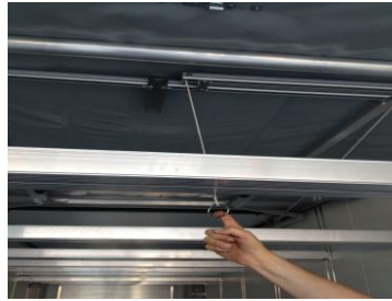
Arretierungsbolzen durch Ziehen der Schnur entriegeln
