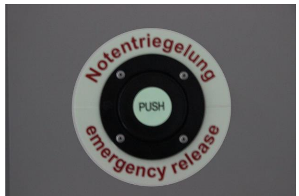
Bild Notentriegelung in Dunkelheit mit kreisrundem leuchtendem Textband
