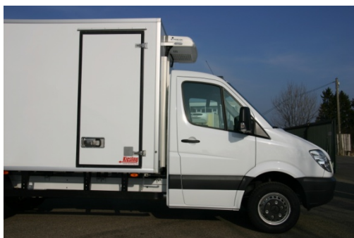
Große Verwirbelungen im Bereich der Kühlmaschine stören die Aerodynamik
