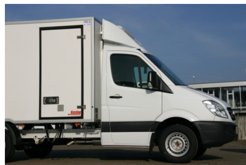
Die Kraftstoff- Einsparungsmöglichkeit durch die Ausstattung mit Spoiler liegt bei 1,34l/100 km (TÜV)
