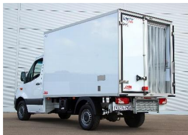
Heckansicht mit Kältevorhang und klappbarem Aufstiegstritt
