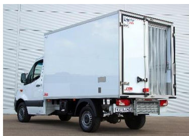
Heckansicht mit Kältevorhang und klappbarem Aufstiegstritt
