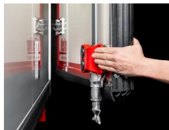
Easy Lock, magnetische Türfeststeller an den Hecktüren
