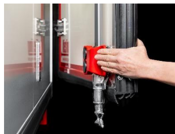
Easy Lock, magnetische Türfeststeller an den Hecktüren
