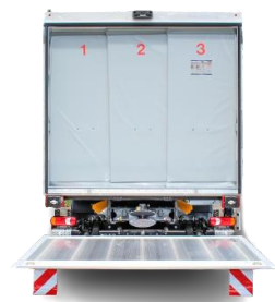
Ohne Hecktüren mit Cool Slide, Verschluss durch Ladebordwand, mit ATP/FRC
