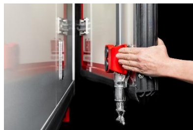
Easy Lock, magnetische Türfeststeller an den Hecktüren
