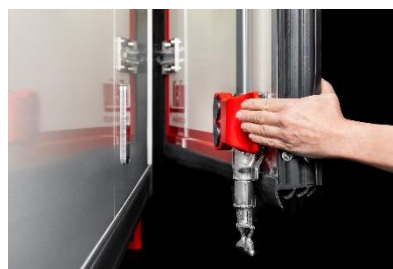
Easy Lock, magnetische Türfeststeller an den Hecktüren
