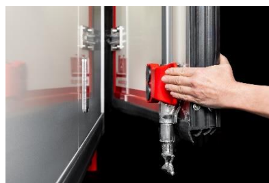
Easy Lock, magnetische Türfeststeller an den Hecktüren
